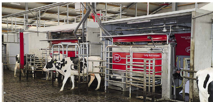
Hoe hoog het verbruik van het Lely automatisch melksysteem A5 met twee boxen uitpakt onder praktijkomstandigheden, wordt inzichtelijk gemaakt in onze vier scenario's. Foto's: Zäh
